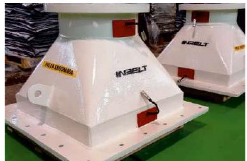
Chutes revestidos y con "Control de Desgaste"
