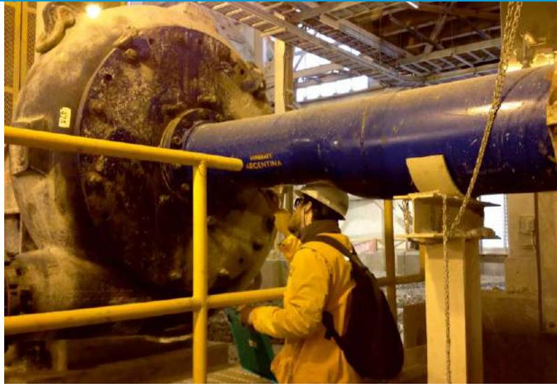
Las bombas son equipos indispensables en las plantas de procesamiento de minerales pues se encargan de impulsar el traslado de la pulpa a los diferentes puntos del proceso.
