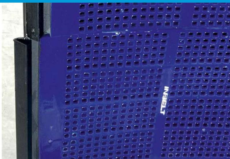
Las **zarandas** son equipos de clasificación utilizados en la industria minera, canterera, cerealera, entre otras. Para realizar su labor de cribado emplean mallas de distintas configuraciones, geometrías y materiales. En Inbelt, diseñamos y fabricamos tanto paneles de dimensiones estándar como 305x305mm (1x1 ft) y 305x610mm (1x2 ft) como paneles personalizados y de mayores dimensiones como 68x55 In.
