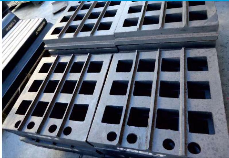
Con el fin de reemplazar en las máquinas de clasificación únicamente las superficies o zonas de cribado deterioradas por el uso, se dividen las superficies totales en módulos con el consiguiente ahorro.
